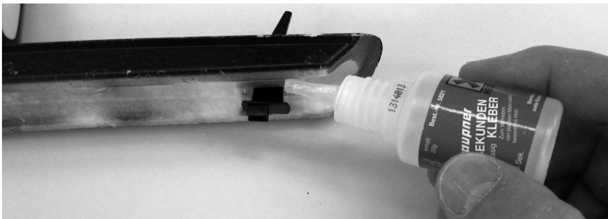
Die Abbildung zeigt das Einkleben des Sicherungsclips in die Kabinenhaube.
