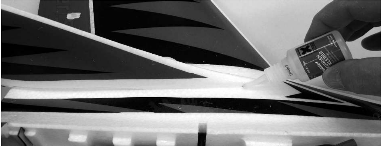
Die Abbildung zeigt das Einkleben der Seitenflossen.
