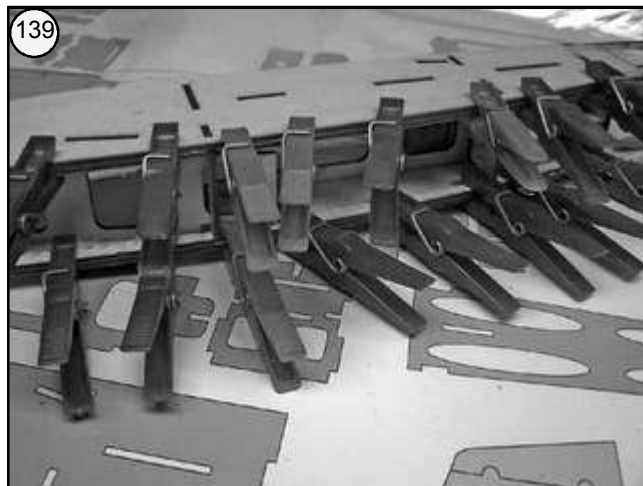
Bild 139 - Restliche Rumpfgurte R 25 - R 27 einkleben.
