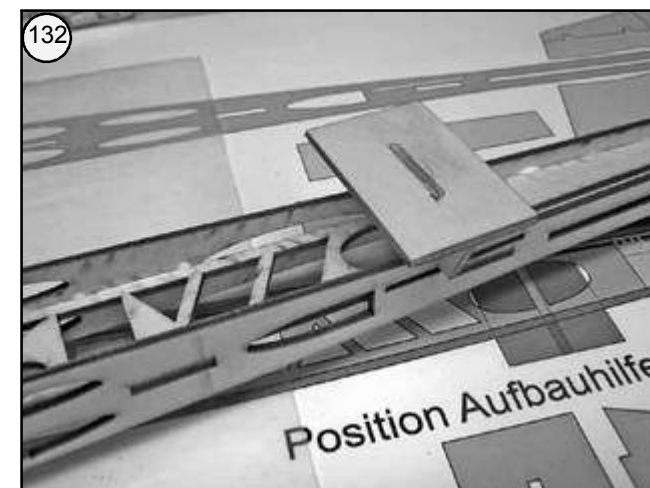
Bild 132 - Rumpf vom Baubrett lösen und umwenden.
