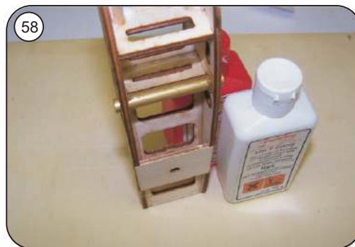
Steckungsrohr M 9 mit Epoxy einharzen
