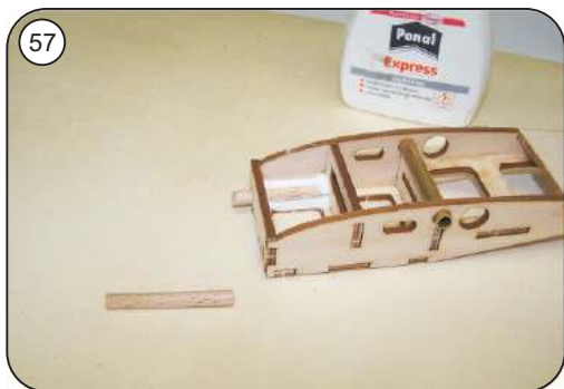
Steckungsdübel M 8 einkleben, auf gute Verklebung achten !
