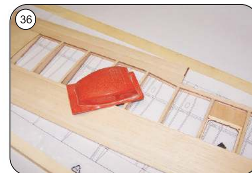
Gesamte Tragfläche sauber verschleifen
