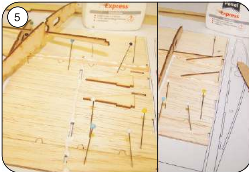
Rippe F 6 mit Formstütze F 7 und Winkelstützen F 8 einleimen
