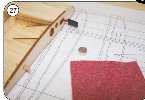
Magnet F 29 mit Schleifpapier anrauen
