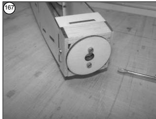
Bilder 167 und 168 - Hilfsspant MT 13 am Motorspant anschrauben und den Rumpfkopf mit Schleifklotz und feinem Schleifpapier verrunden. Hilfsspant MT 13 dient dabei als Schleifanschlag.
