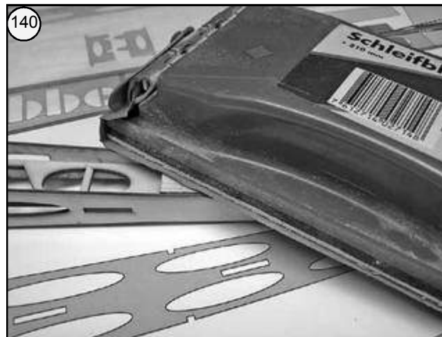
Bild 140 - Den gesamten Rumpfrohbau mit feinem Schleifpapier überschleifen.
