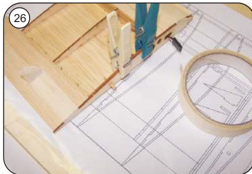
Wurzelrippe F 27 mit Buchendübel F 28 ausrichten, mit Kreppband und Klammern bis zum Durchtrocknen fixieren
