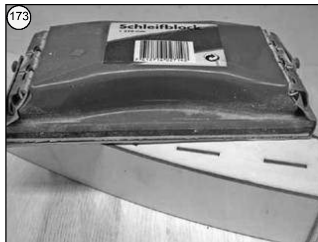
Bilder 173 und 174 - Die Kanten im vorderen Rumpfbereich leicht brechen, den gesamten Rumpfkopf überschleifen.
