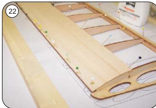
Beplankung bis zum Durchtrocknen mit Stecknadeln fixieren
