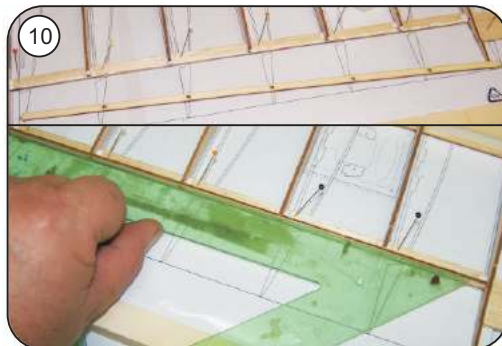
Querruder- Anschlag F 18 einkleben und gerade ausrichten
