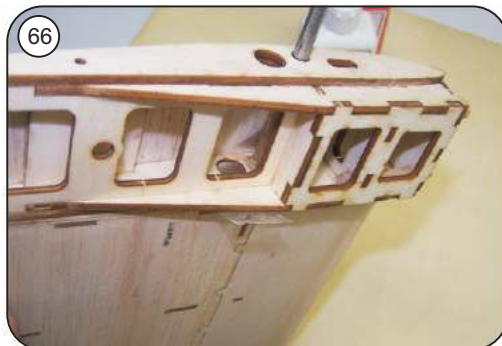
Magnet M 13 von der Innenseite einstecken und mit Epoxy gut einharzen
