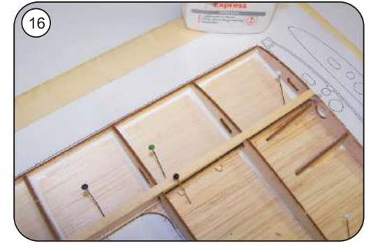
Alle Klebestellen von F 1 mit Holzleim nachkleben
