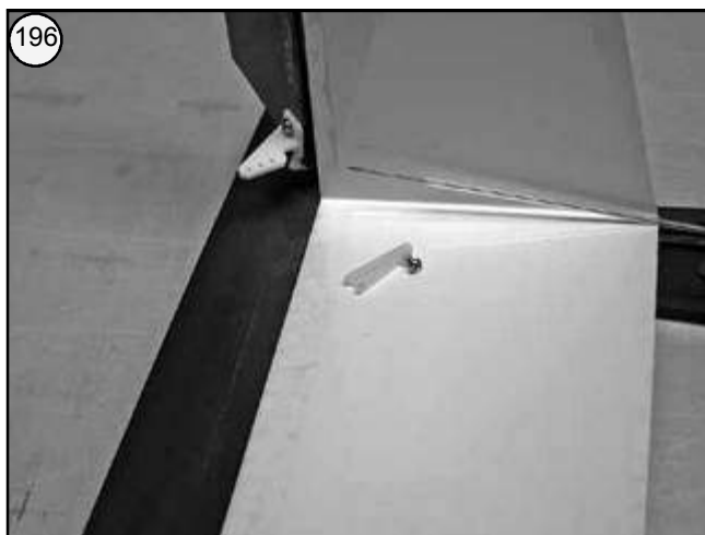
Bild 196 - Gestänge am Ende auf entsprechende Länge abschneiden, Länge des Gabelkopfes dabei berücksichtigen.
