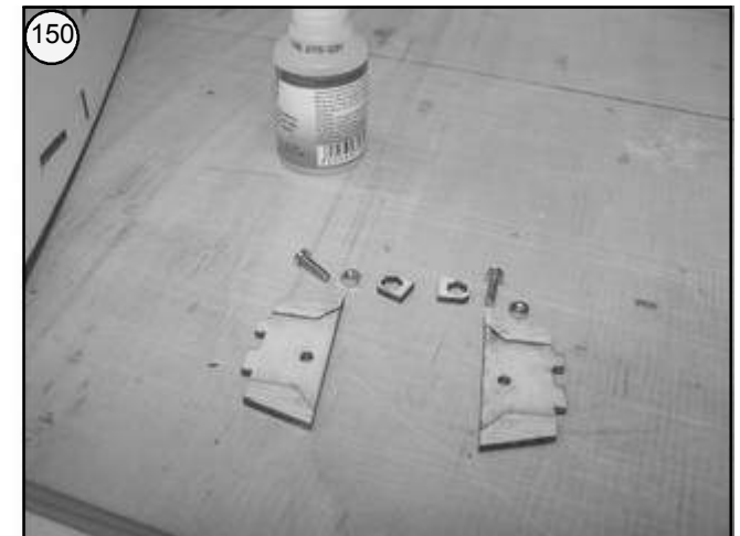
Bild 150 - Gewindeschrauben und Muttern selektieren.
