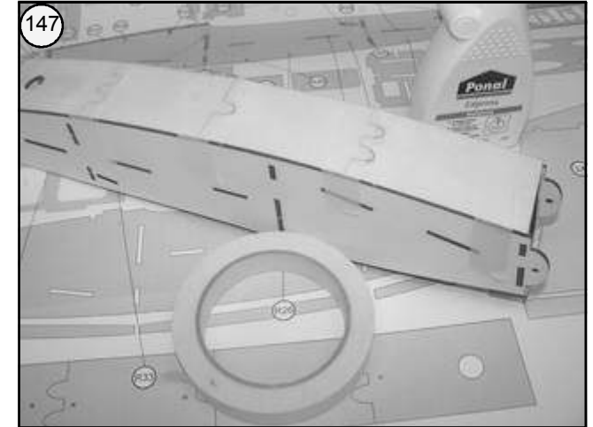
Bild 147 - Bodenbeplankung auf die Unterseite des Rumpfes kleben, mit Kreppstreifen bis zum Durchtrocknen verspannen.
