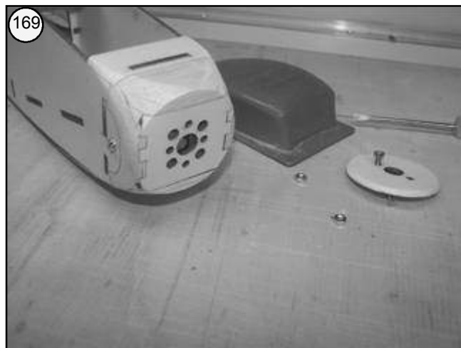
Bild 169 - Hilfsspann Mt 13 wieder abnehmen.
