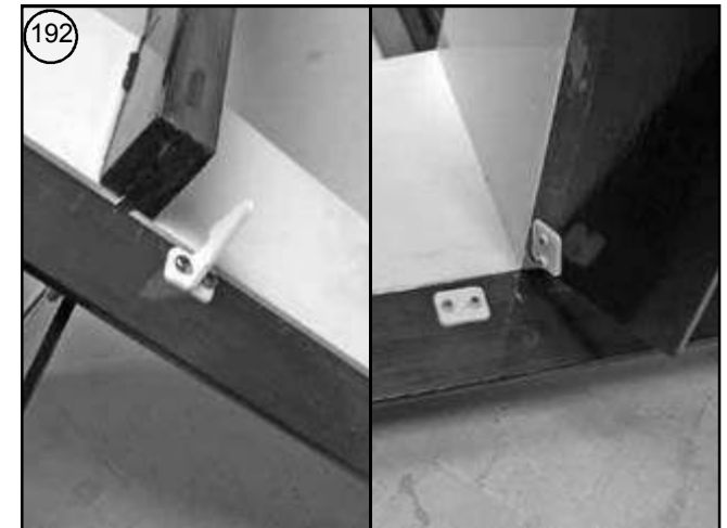
Bild 192 - Ruderhorn am Höhenruder anschrauben.
