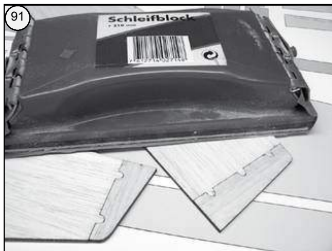
Bild 91 - Leitwerke, insbesondere die Klebestellen mit feinem Schleifpapier überschleifen.
