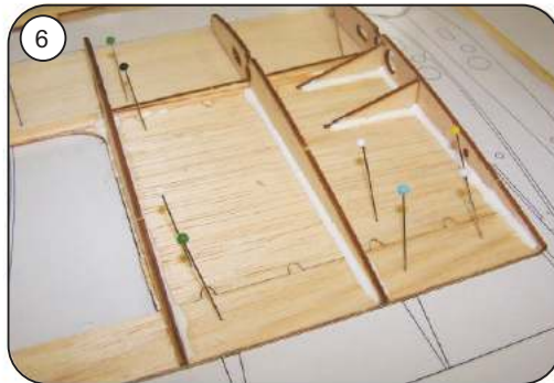
Rippe F 9 einleimen und gerade ausrichten, Klebestellen nachträglich vermuffen
