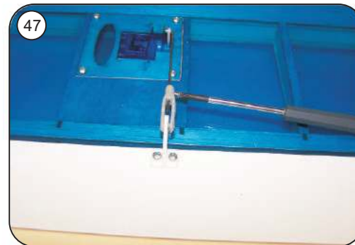
Servo und Querruder in Neutralstellung bringen und mit der Klemmschraube am Gabelkopf sicher fixieren
