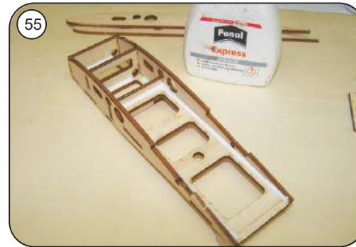
Alle Klebstellen nachträglich satt mit Holzleim vermuffen
