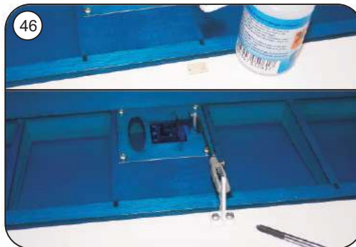
Ruderhorn mit Speedkleber aufsetzen und verschrauben
