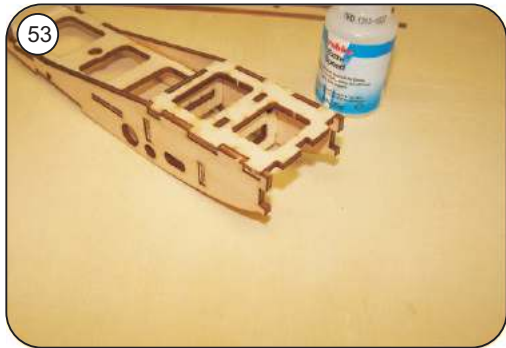
Boden unten M 5 einsetzen und anheften
