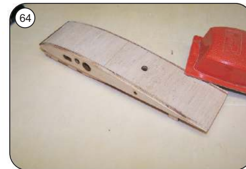
Mittelstück sauber verschleifen
