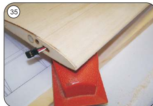
Beim Verschleifen auf den Profilverlauf achten ( s. Schnittzeichnung im Plan )
