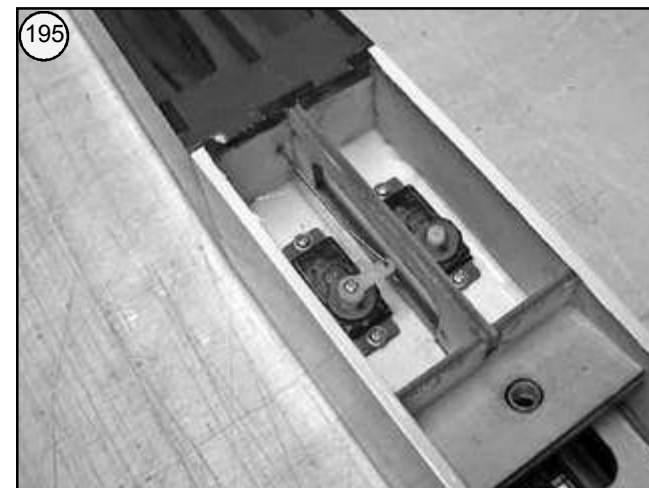
Bild 189 - Servos mit der Fernsteuerung auf den Nullpunkt einstellen. - Servohebel aufsetzen und mit der Befestigungsschraube in der Servoachse festschrauben.
