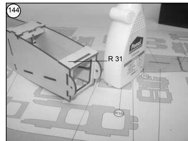
Bild 144 - Deckel R 31 einkleben.
