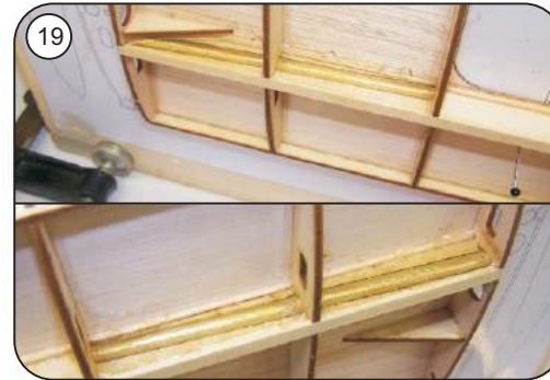
F 23 beidseitig zum Kammholz satt einharzen, Baubrett dazu jeweils bis zum Trocknen senkrecht stellen
