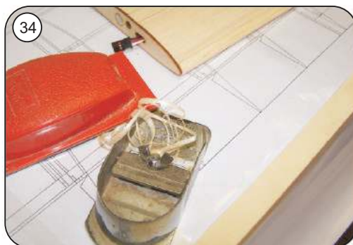
Beplankungen und Nasenleiste sauber verschleifen
