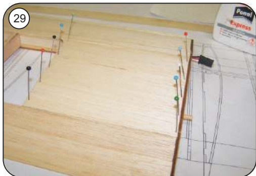
Mittelbeplankung F 30 einpassen und mit Holzleim einkleben
