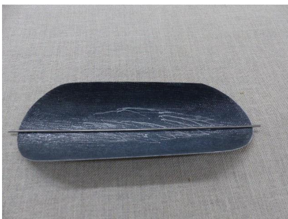
Dépolir la surface
